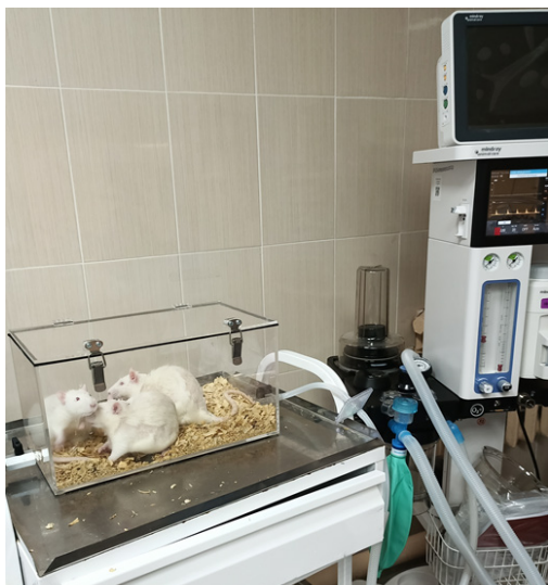
Рис. 1. Подача газовой смеси наркотным аппаратом Mindray animal care Veta 5 в общий бокс для животных объемом 10 л
